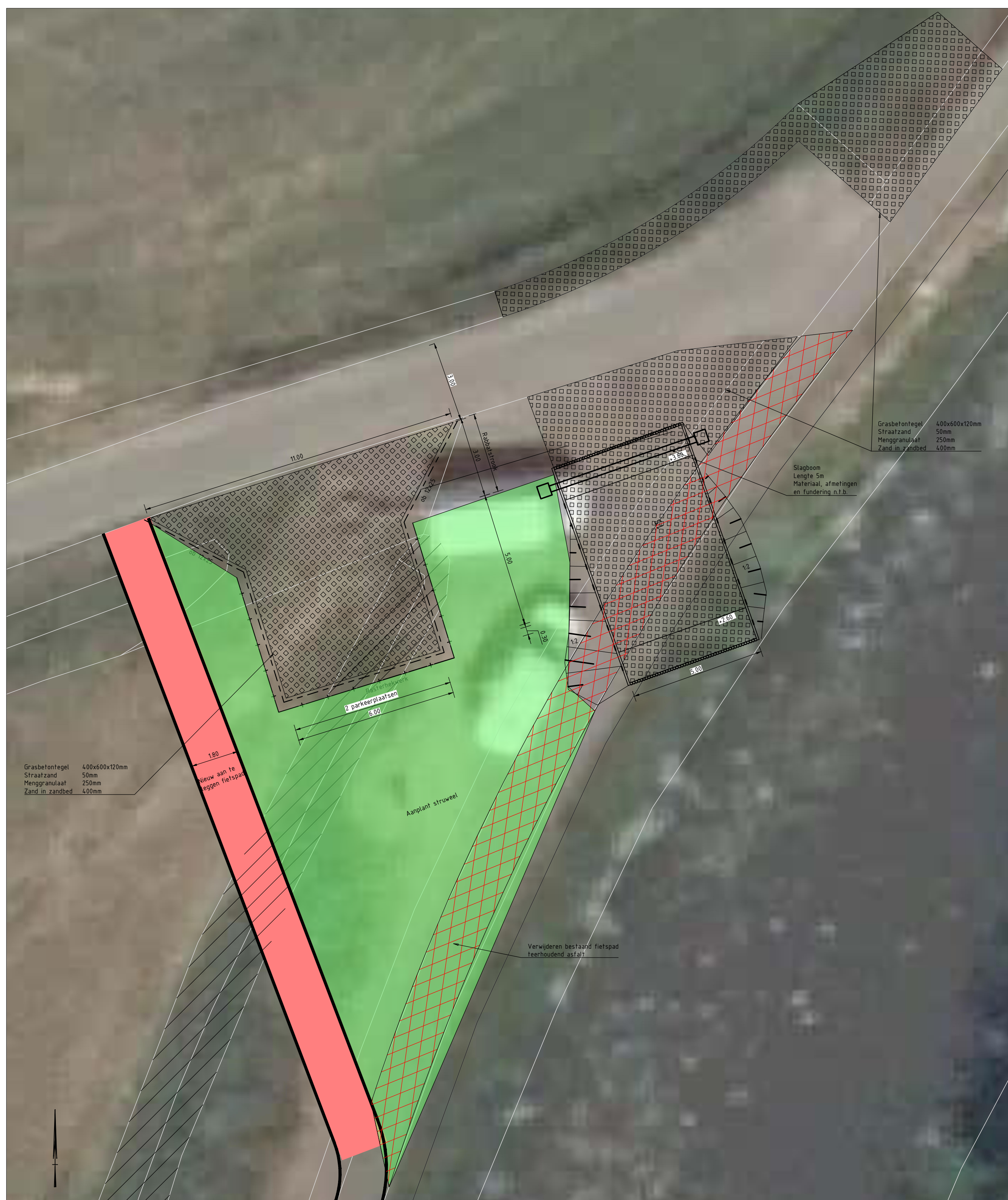
Situatie 7: Parkeerplaatsen en bootinlaatplaats bovenaanzicht Schaal 1 : 100
